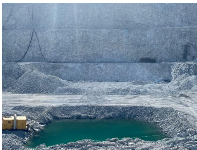
Рисунок 2.15 – Состояния откоса после заоткоски уступа контурного блока 1290001
