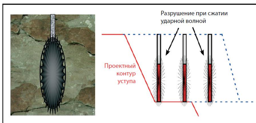
Рисунок 2.3 – Разрушение породы сжатием непосредственно вокруг ВВ
